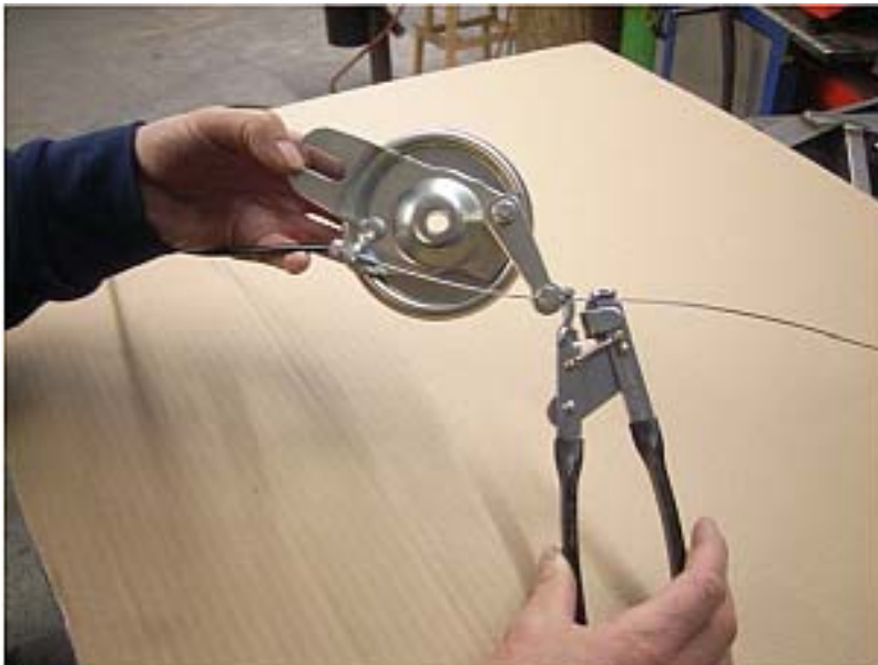
Photo 6 Réglage de la tension des câbles de freins tambour, à l'aide de notre pince spéciale. (Disponible dans nos pages accessoires)
