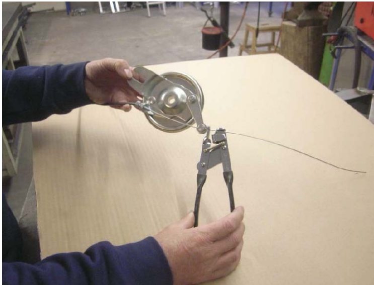
Photo 5 Réglage de la tension des câbles de freins tambour, à l'aide de notre pince spéciale. (Disponible dans nos pages accessoires)
