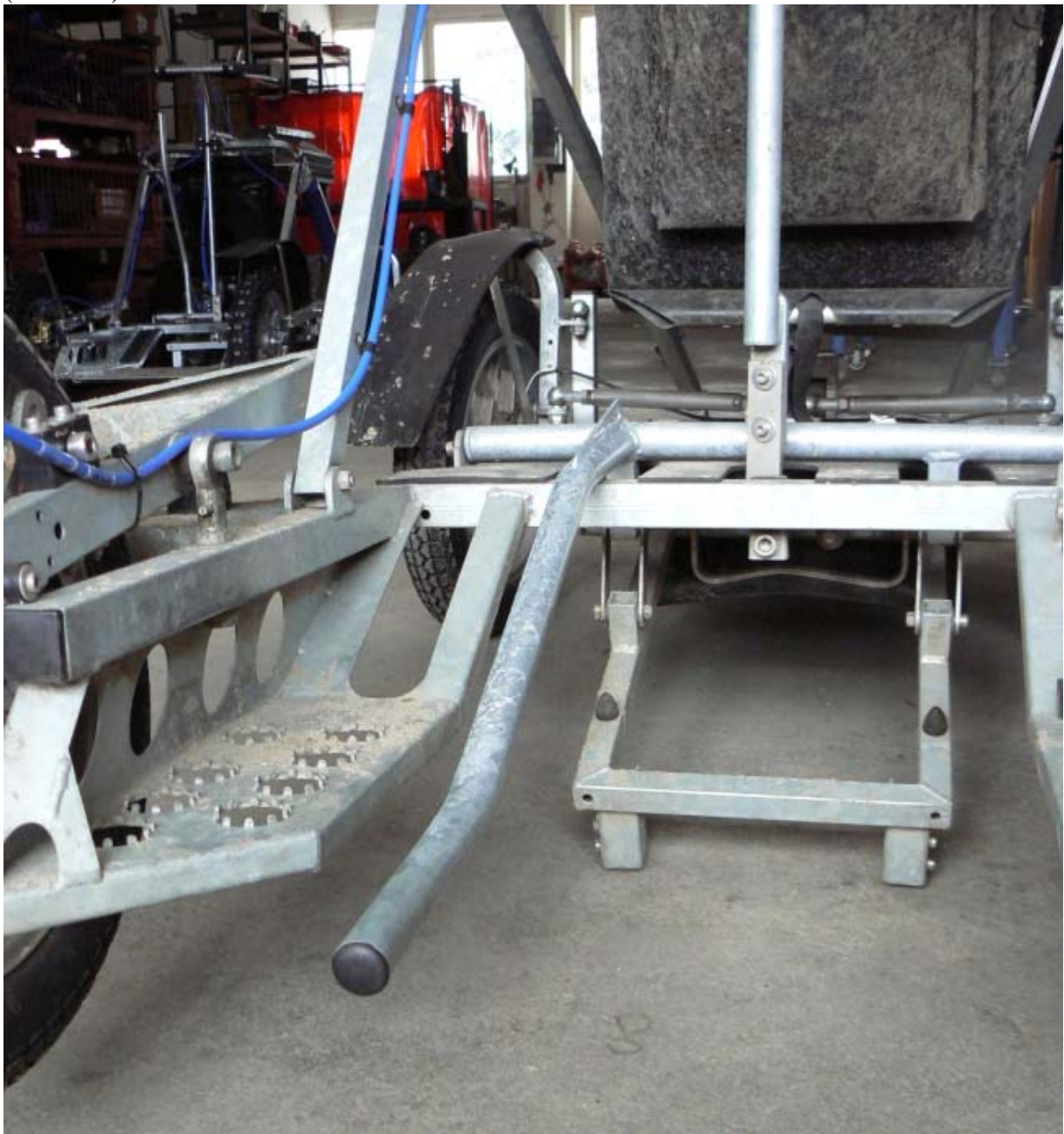
Photo 2 sécuriser le kart avec la griffe d'ancrage.
