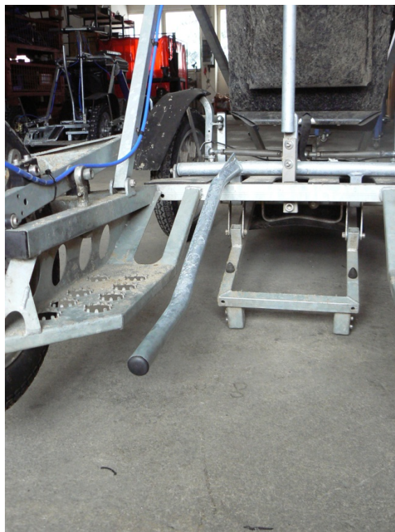
Abb.2 Fixieren mit der Schlittenbremse Securing the cart with the sled-brake
